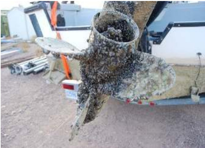
Hélice de bateau infestée de moules zébrées (RPQ 2014)
